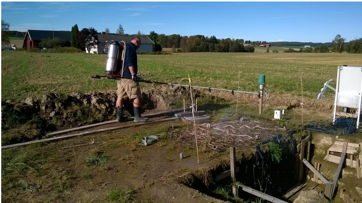
3. ábra Öntözéses módszer bróm és jód talajba juttatásához.
