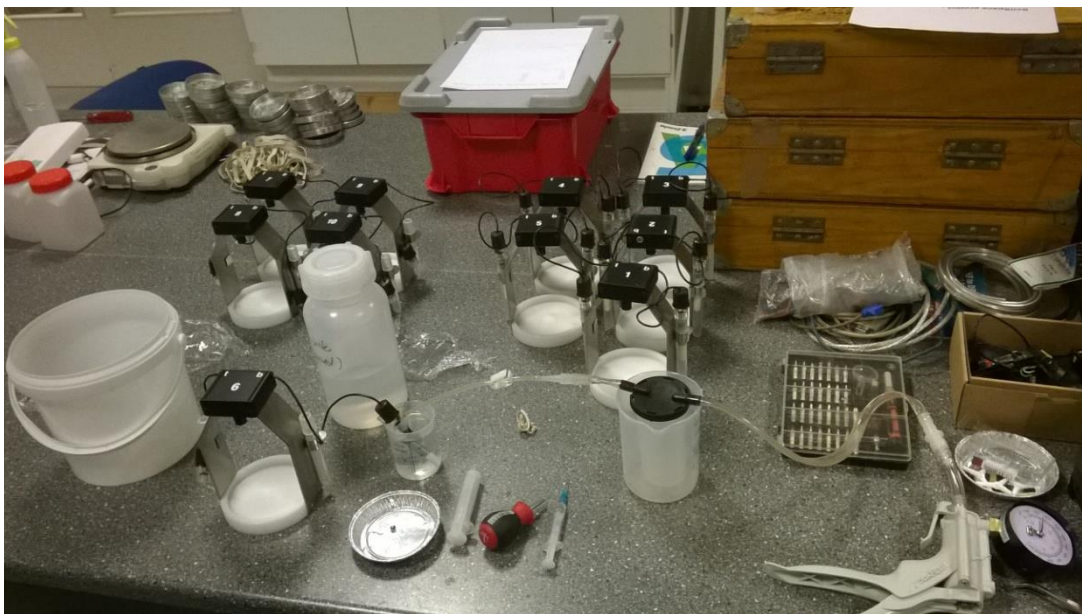
5. ábra Tenzióméterek levegő buborékmentesítése.
