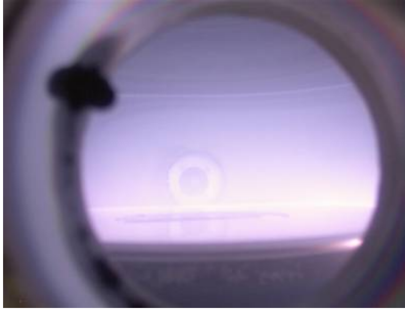
Reactive Ion Etching, közepén egy Si szelet plazma felhőben.
